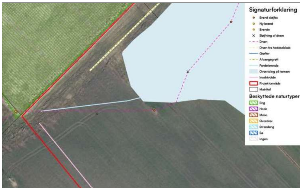
Figur 4-4 Brønden er placeret i et §3 område lige udenfor projektgrænsen. Drænvandet ledes i det eksisterende rør og ud i fordelerenden til overrislingsområdet.
